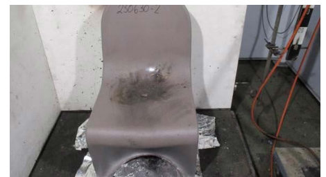
DIN 66084 test, demonstrating pass (Ryno)
